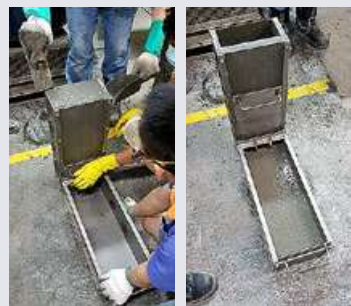
Passing Ability – L-Box Test 通過能力測試 – L型盒測試
