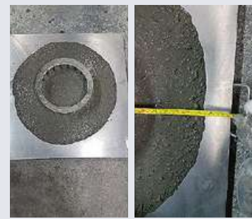
Passing Ability – J-Ring Test 通過能力 – J-RING測試
