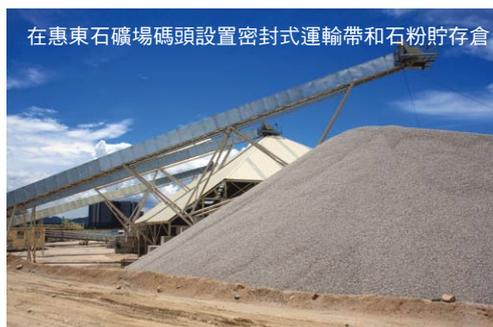
在設計我們的石料付運設施時，我們強調環保控制以在滿足運作需要時，亦同時保護我們的鄰居免受環境污染。例如在惠東石礦場的石料付運碼頭，所有石料運輸帶都是以密封式設計的，以減少塵埃散播；我們亦投放資源興建了石粉貯存倉上蓋以避免塵埃被風吹散到附近範圍。在香港的石料轉運站，我們實施了一些良好操作，例如：設置車輪沖洗設施以避免車輛把污泥帶到公眾道路、在各貯料倉、工地道路和空曠地面灑水以壓抑塵埃散播、石粉貯存倉遮蓋、和定期沖洗道路和附近範圍。實施這些措施讓我們在滿足市場需求時能堅守我們對保護環境的承諾。
