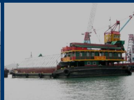
密封設計的生產線和石料運載船控制了污染物傳播往四周的環境，亦可以把機械運作的噪音在源頭予以隔離
