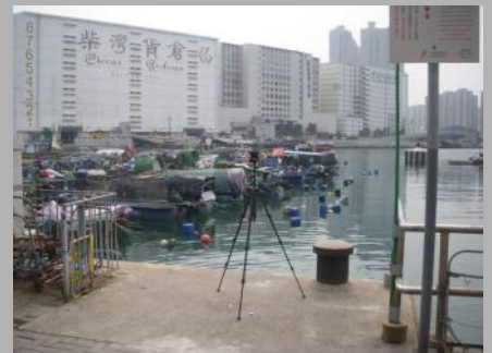
進行噪音監察量度感應強接收者位置的噪音量
